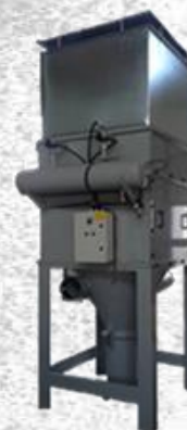
porleválasztó berendezés tűveszélyes csiszolátpor leválasztására
